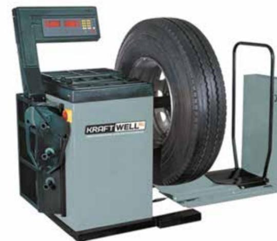
Станок для балансировки колес легковых, грузовых автомобилей, микроавтобусов и автобусов.
